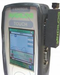
O software Datastick II e a sua chave USB permitem-lhe **guardar automaticamente ou a pedido os resultados (cálculos, estatísticas) e as curvas dos seus testes numa chave USB** à sua escolha. O software incluído permite-lhe visualizar curvas e dados de medição no seu computador e beneficiar do desempenho da Caligraph.
